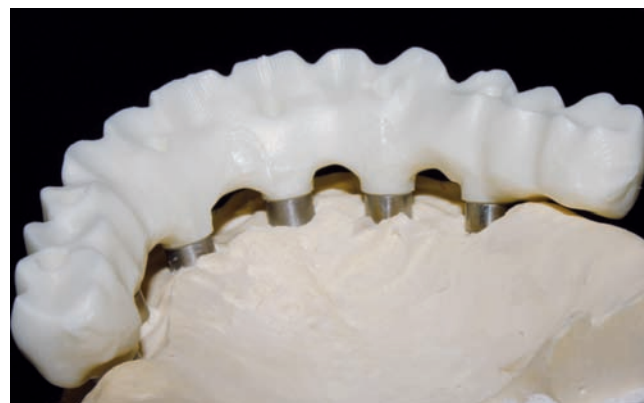
Figuras 10a y 10b. Comprobación de los ajustes y los espesores de la estructura para llevar a cabo el ceramizado de la misma.
