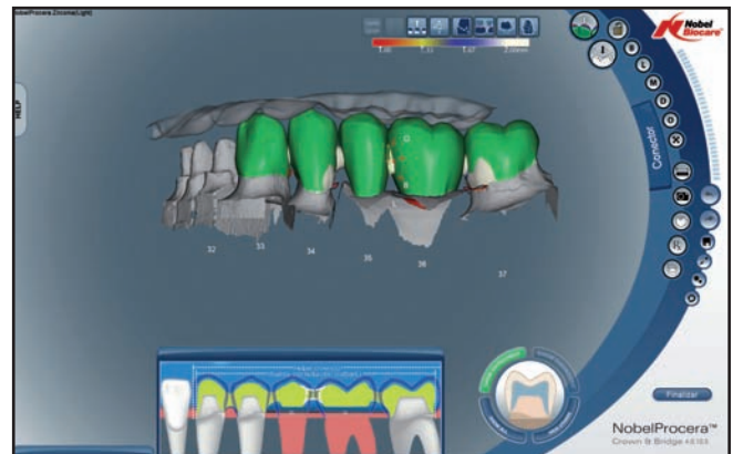
Figura 22. Diseño del puente de circonio con el programa Cut Back®.
